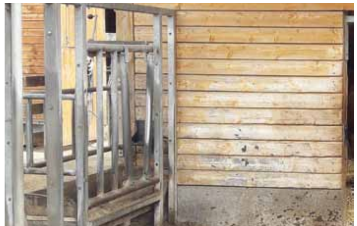
Durch das Umlegen des Hebels verengen sich die stabilen Metallstäbe am Futterplatz v-förmig und halten den Bullen fest. Fotos: SVLFG
