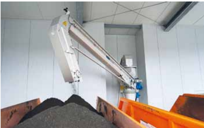
Verteilschnecke Ro8TC mit Höhenstandmessung und motorischer Positionsverstellung
